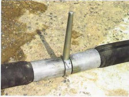
Abbildung 7: Verbundene Schlauchendverschlüsse mit Koppelring und Dorn. Deutlich sichtbar ist der wesentlich kleinere Durchmesser der Stahl-Presshülsen im Vergleich zum Schlauch.
