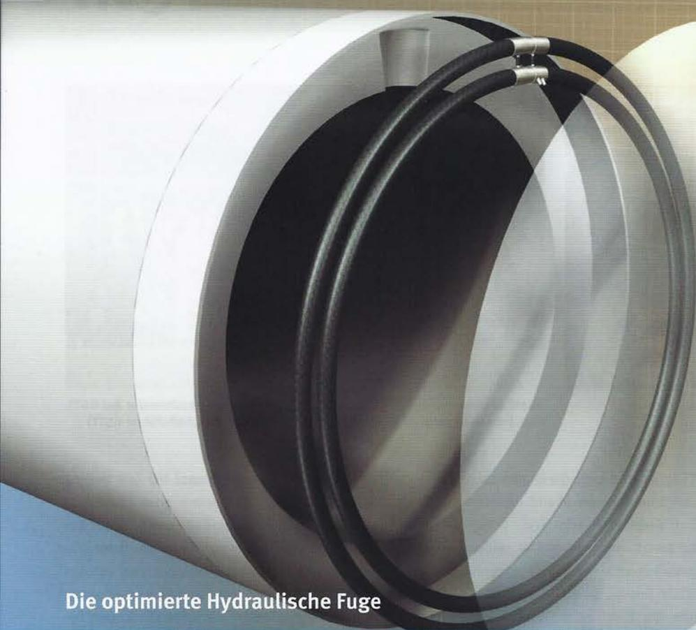
Abbildung 1: Ein oder zwei konzentrisch in die Rohrverbindung eingelegte Hydraulikschläuche ersetzen den Druckübertragungsring aus Holz oder Spanplatte. | Grafik: VisaPlan
