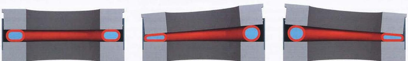
**Abbildung 2: Verhalten des CoJackHydra-Schlauchs bei geradem Vortrieb (links) und Abwinklung der Vortriebsrohre (links und rechts)** | Grafik: VisaPlan
